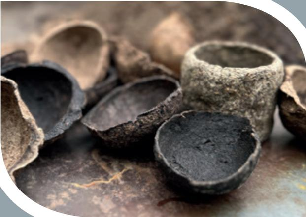
Aus Kaffeesatz und natürlichen Rest-, Roh- und Wertstoffen entstehen an dieser Station kompostierbare Pflanztöpfe. Dabei werden Materialien sorgfältig abgewogen, abgemessen und vermengt. Das Experiment macht erlebbar, wie geschlossene Materialkreisläufe funktionieren und welche Rolle Bioökonomie für eine ressourcenschonende Zukunft spielt.
